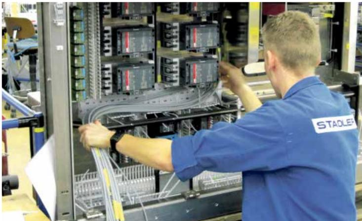
Stärkung des dualen Bildungssystems: Automatiker im 4. Lehrjahr beim Verdrahten eines 400-V-Steuerstrahles für ein Schienenfahrzeug für den Regionalverkehr.
